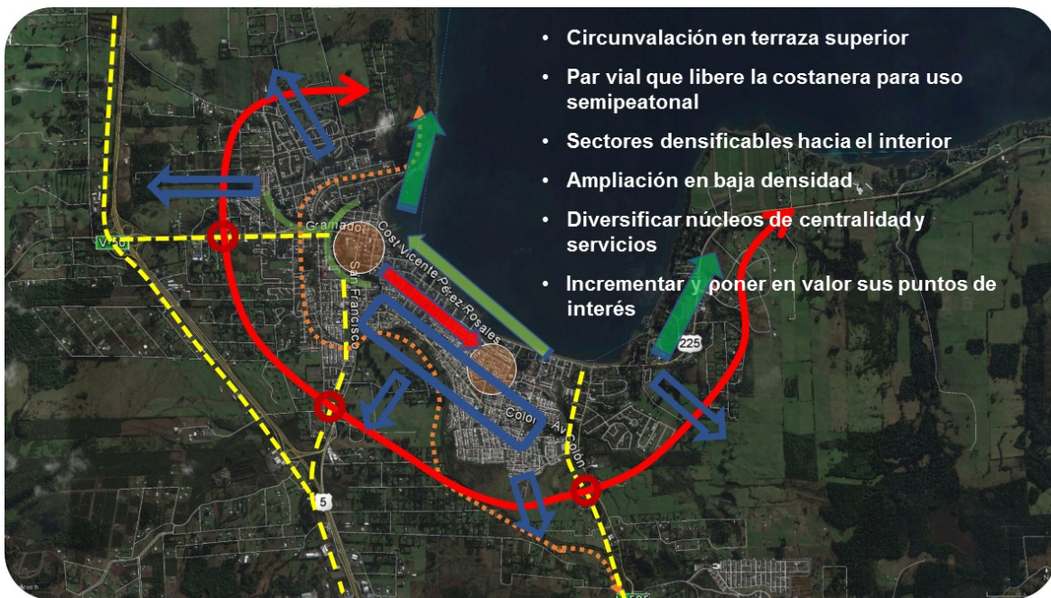
Figura 91. Esquema de componentes de la estructuración de Puerto Varas
